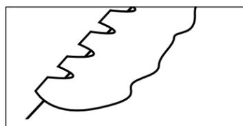
Le brûleur doit être remplacé: Flammes jaunes ondulantes.
